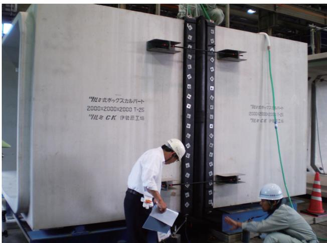
水密試験状況 (継手部の確認)
